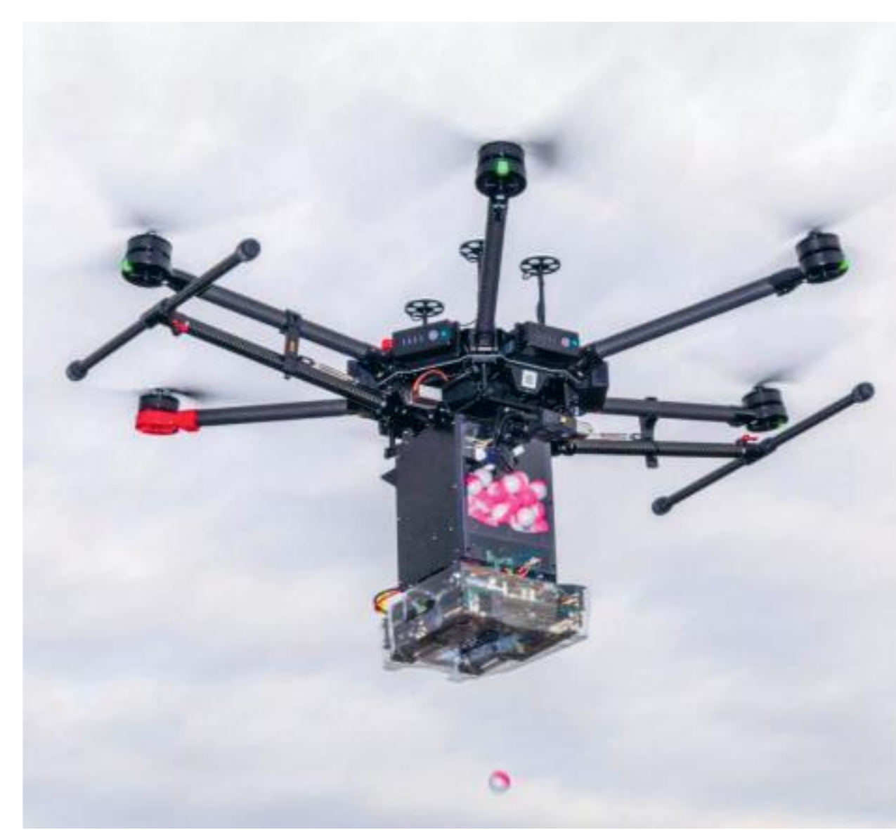
Ignis, Drone Amplified Het Ignis-systeem van Drone Amplified steekt kleine vuren aan om branden te sturen. Dit gebeurt met een soort pingpongbal gevuld met kaliumpermanganaat. Deze krijgen voordat ze worden uitgeworpen een injectie met antivries, zodat de ballen ontploffen wanneer ze de grond raken, en er vuurtjes ontstaan.
